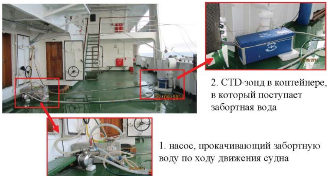
Рис. 2.6. Фотографии проточной системы на борту НИС «Академик Мстислав Келдыш»
